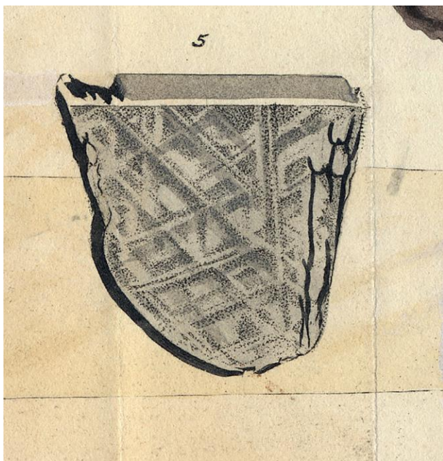
Obrázok č. 10. Jedno z prvých zobrazení lenartovského meteoritu, ktoré podľa popisu bolo zhotovené z „odrezku meteoritu pochádzajúceho z uhorského Lenartova“ tak, že „jeho bol obrúsený a jeho povrch leptaný zriedenou kyselinou dusičnou, čo odhalilo smer kryštalizačných platničiek; platničky sú považované za rovnobežné s povrchom vzájomne sa pretínajúcich pravidelných oktaédrov“ (SOWERBY 1820). Láskaosť Wendella Wilsona (The Mineralogical Record Inc.)
